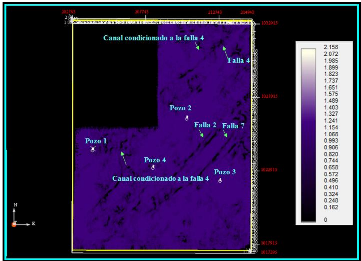
Figura 5. 59 . Corte en tiempo (1544 ms) del cubo de similaridad. Se aprecia un canal condicionado a la falla 4.
