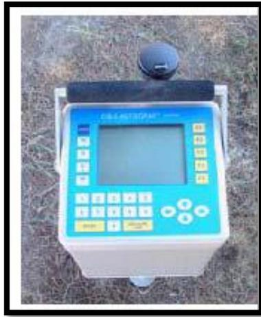
Figura 4.1 Gravimetro Sintrex CG-5 utilizado para la adquisición de los datos.
