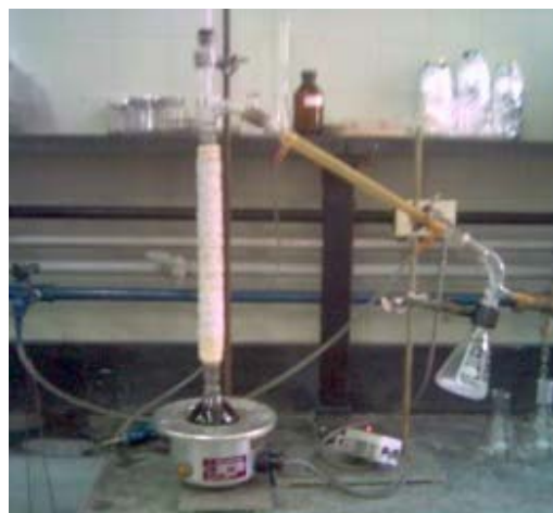
FIGURA 8. SISTEMA DE EXTRACCIÓN DE SOLVENTE PARA HTP.
