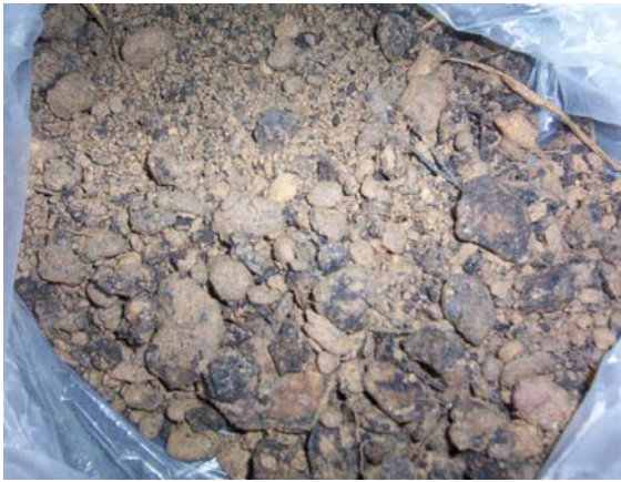
Muestra de tierra impactada con crudo
