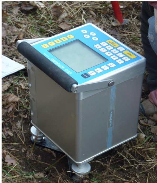
Figura 11. Gravímetro Autograv Scintrex CG-5
