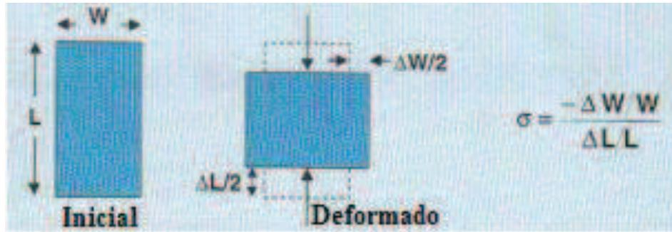
Figura 2.3: representación gráfica del efecto que describe el módulo de Poisson. Tomado de Chelotti et al. (2009)
