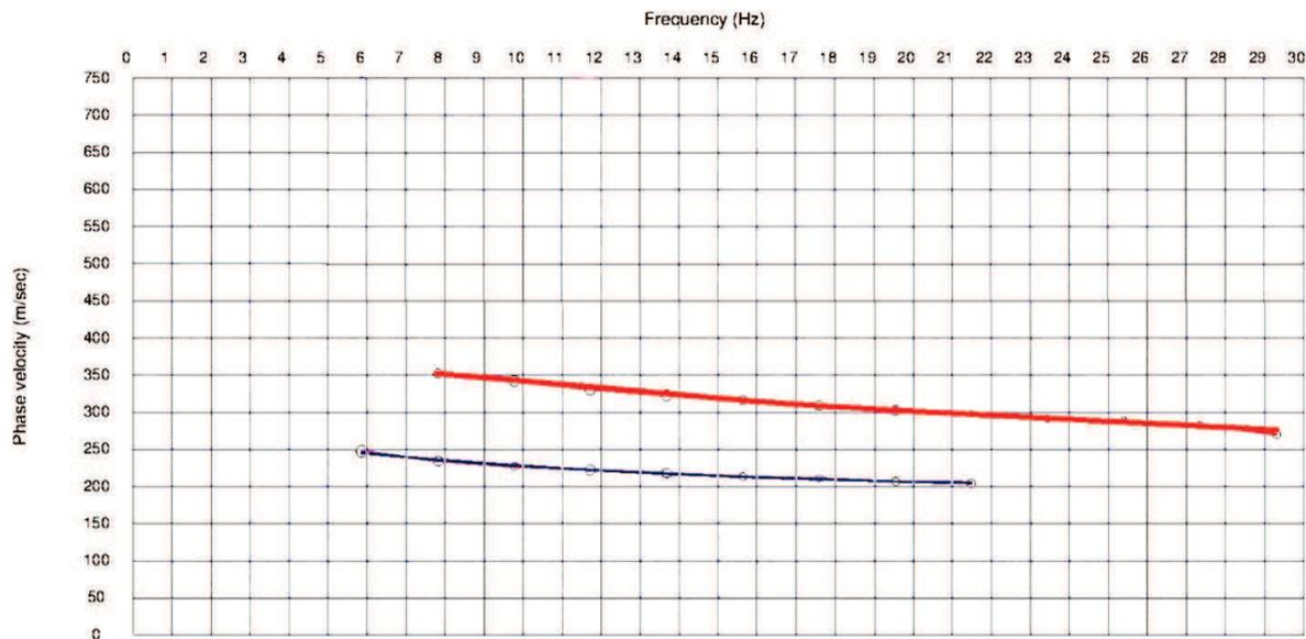
Figura 5.1.1: curvas de dispersión tipo obtenidas para los tendidos de sismica de refracción en la zona de cárcavas en azul, y en la zona de llanuras en rojo
