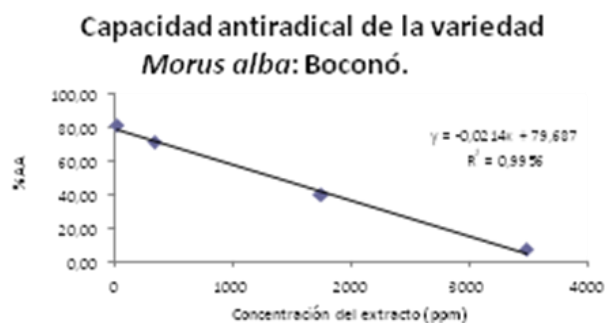
Figura 25. Curva de calibración para determinar la capacidad antiradical de la morera, variedad Boconó.
