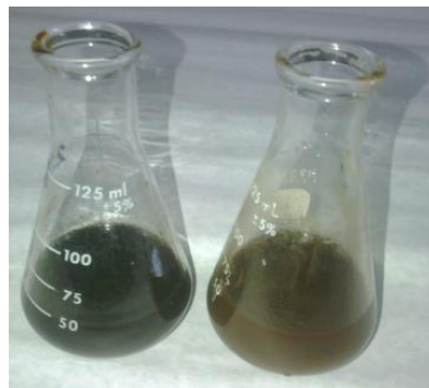
Figura 7. Cambio de color en la titulación ácido- base, para determinar el número ácido del lubricante usado.
