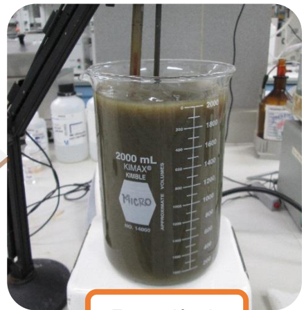
Extracción de proteínas a pH 11
