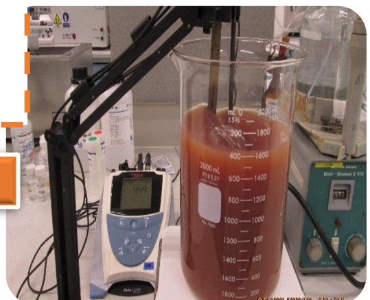
Precipitación de proteínas a pH 4,5
