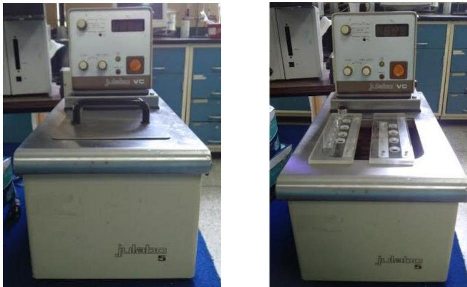
Fig. 18.- Baño termostático marca Julabo modelo VC-5 ( $\pm 0,5$  °C) adaptado para HS.
