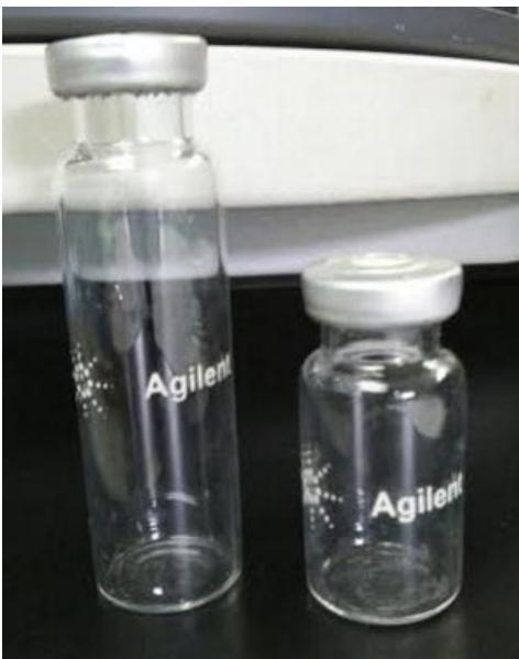
**Fig. 19.- Viales transparentes marca Agilent con un volumen de 12 y 20 mL.**
