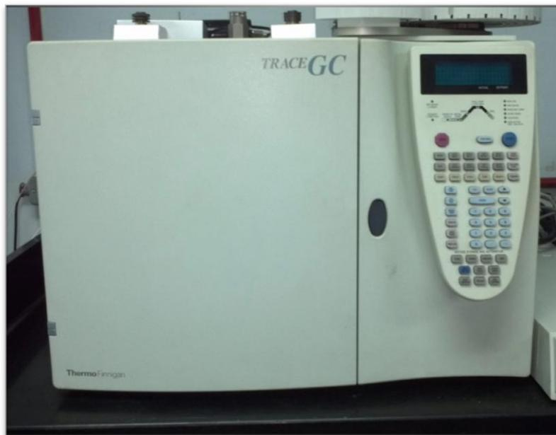
**Fig. 16.- Cromatógrafo de gases Thermo Finnigan, modelo TRACE GC.**
