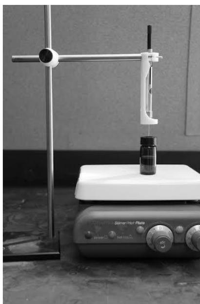
Figura 9. Montaje para los ensayos: dispositivo de MEFS, cuya fibra es expuesta dentro de la fase líquida de la muestra, contenida en un vial, sobre una plancha de calentamiento.
