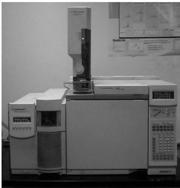
Figura 5. Cromatógrafo de Gases marca Agilent Technologies, con detector de Espectrometría de masas.
