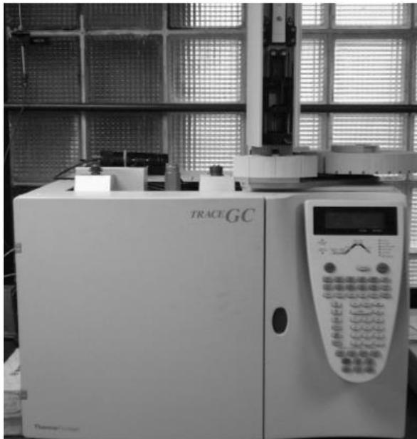
Figura 4. Cromatógrafo de Gases marca THERMO QUEST, con detector de ionización a la llama
