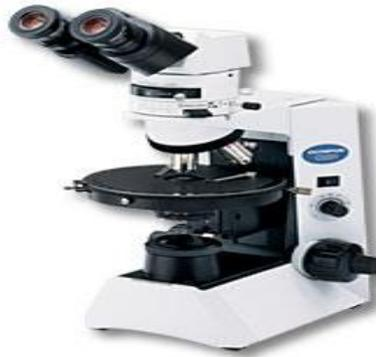
**Figura 39.** *Microscopio de luz polarizada usado en el reconocimiento de minerales pesados.*
