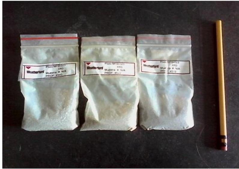
**Figura 20.** Muestras de arenas a las cuales se les realizaron el proceso de tamizado, pertenecientes al núcleo MFD-023.
