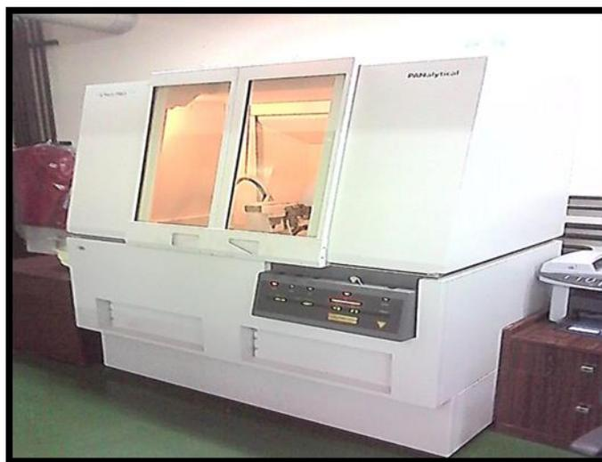
**Figura 31** .Difractómetro de rayos X, ubicado en las instalaciones de PDVSA- INTEVEP
