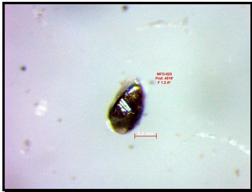
**Figura 61.** Micrografía de un grano de monacita color ámbar y translucido con forma ovalada.
