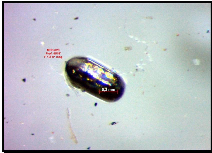
**Figura 59.** Micrografía de un grano de rutilo color amarillo negruzco con forma alargada.
