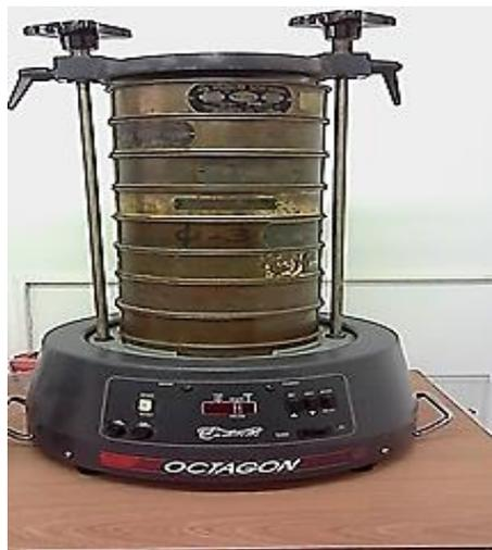
**Figura 21.** Equipo utilizado para realizar el tamizado de las muestras (Tambor Octagon).
