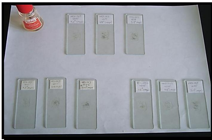
**Figura 29** .Secciones montadas para las fracciones magnéticas 0,4A-0,8A y 1,2A de los 3 intervalos de profundidad del pozo MFD-023.
