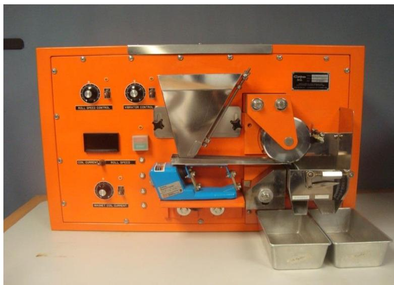
**Figura 23** .Separador magnético de alta intensidad Magnet-lift modelo Carpo MLH (13) III-5. T.
