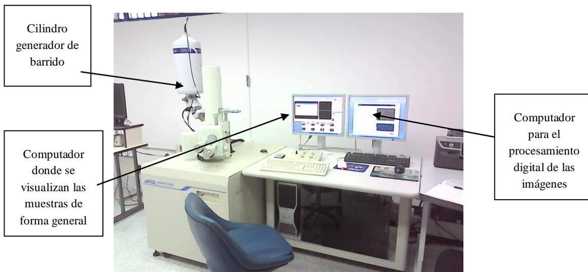
**Figura 34.** *Microscopio Electrónico de Barrido (MEB), marca JEOL, modelo JSM-3690. Ubicado en la Unidad de Laboratorios (U.S.B).*
