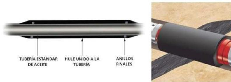
Imagen 2.20 Empacador Inflable. Fuente: Blanca A 2010 .Fracturamiento Hidráulico Multietapas.Trabajo Especial de Grado Universidad Autónoma de México, México DF
