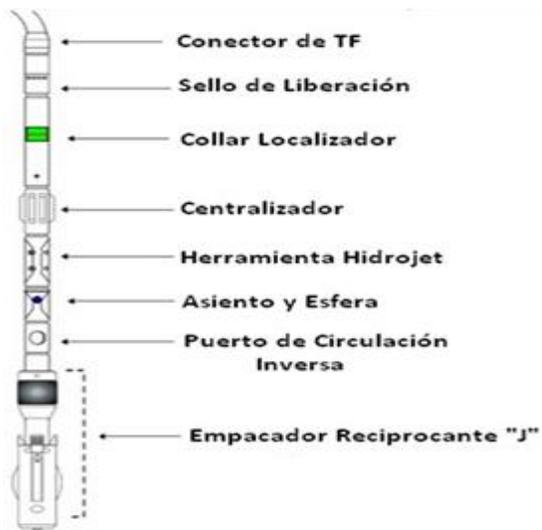
Figura 2.18 Equipo de Fondo HPAP Fuente: Blanca A 2010 .Fracturamiento Hidráulico Multietapas.Trabajo Especial de Grado Universidad Autónoma de México, México DF
