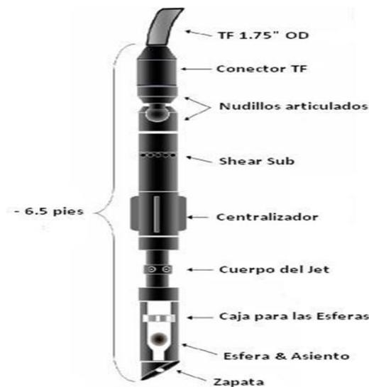
Figura 2.17 Equipo de fondo del método HPAP con PPD Fuente: Fracturamiento Hidráulico Multietapas. Trabajo Especial de Grado Universidad Autónoma de México, México DF BLANCA A (2010)
