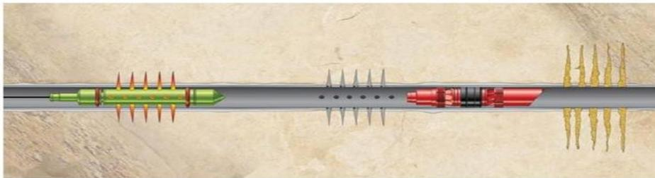
Figura 2.19 Ilustración del Perf & Plug, donde se utiliza un Bridge Plug para aislar las etapas que se van a fracturar y se perfora para crear las fracturas en las etapas deseadas. El número y tamaño de las perforaciones para cada etapa a menudo son limitados para asegurarse de que cada etapa reciba el fluido de tratamiento tomada de Fracturamiento Hidráulico Multietapas. BLANCA A (2010)
