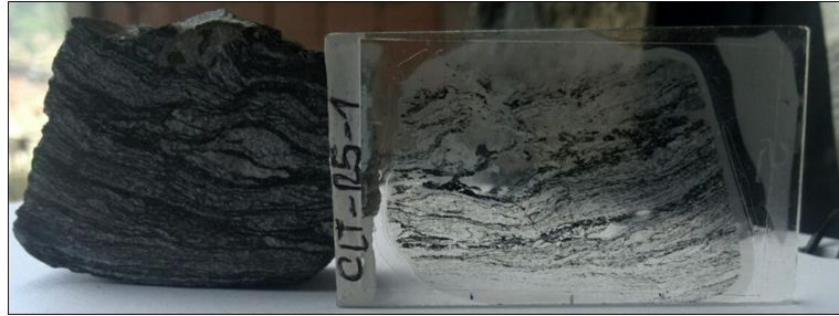
Figura 42. A la der. Se muestra sección delgada de la muestra CLT-R5-1 y a la izq. Taco de donde se tomó la muestra; se observa en el centro, lente de cuarzo rodeado por gran cantidad de grafito.
