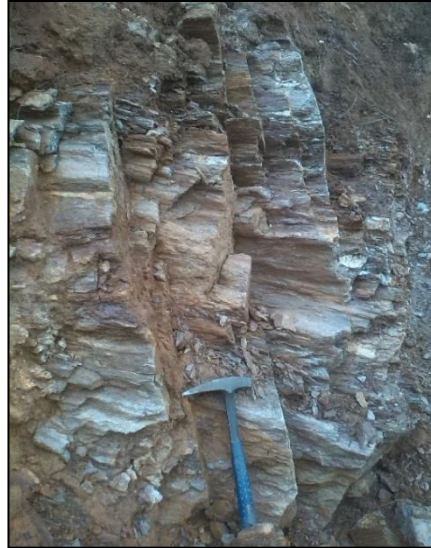
Figura 14. Familia de diaclasas con dirección perpendicular a la dirección de foliación, estas diaclasas no presentaban relleno ni separación.
