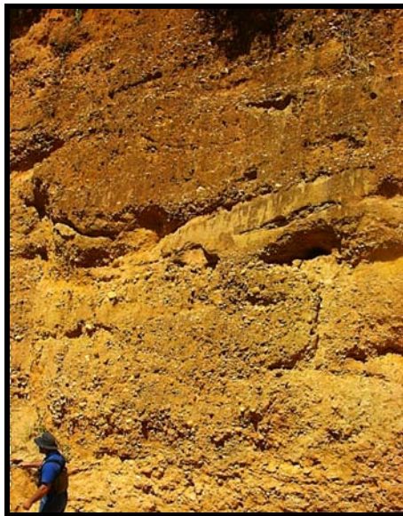
FIGURA 5.28. Conglomerado rojizo a marrón con clastos de tamaño peña y peñón y bien compacto (afloramiento Car 21, orientación de la foto: N55°W).
