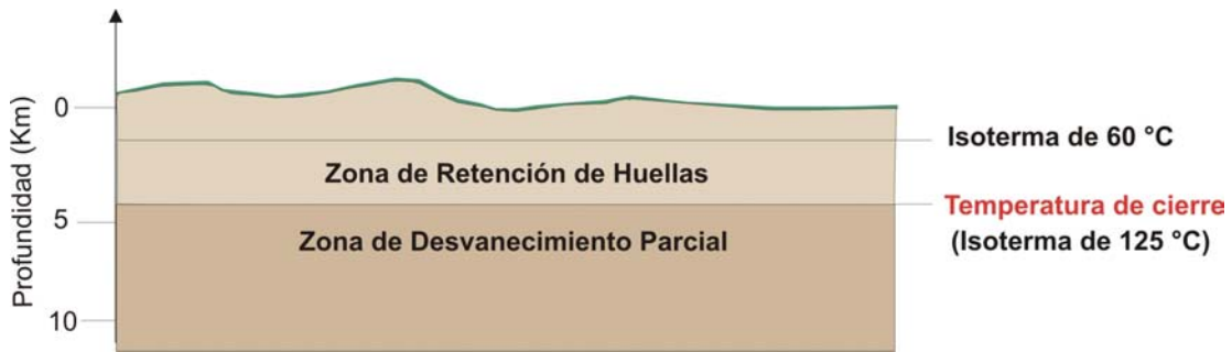
Figura 3.1. Gráfico ilustrativo de la temperatura de cierre y de las zonas de producción de huellas y de desvanecimiento parcial, en apatitos.
