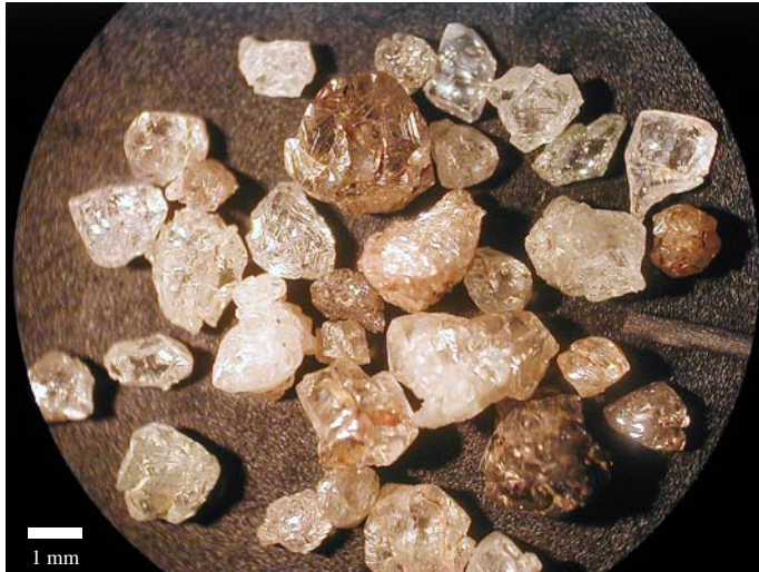
Foto 45. Conjunto de diamantes de la variedad bort. Se destaca el aspecto rugoso y caótico de estos especímenes.
