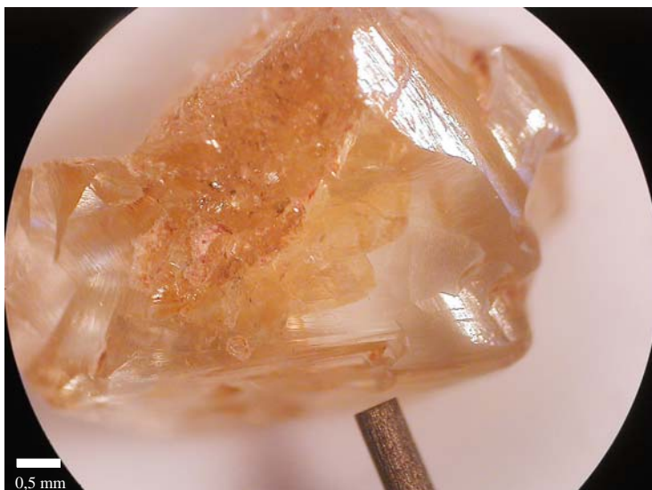
Foto 101. Manchas de óxido que alcanzan el interior de un cristal, a través de fracturas internas (var. cristalina).
