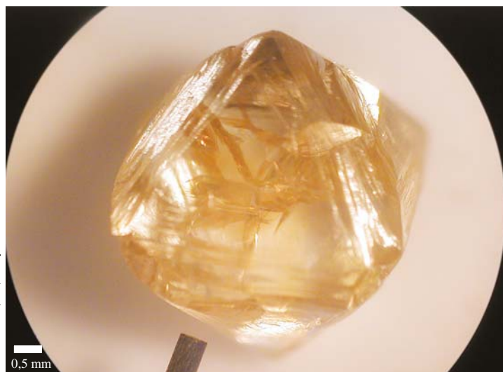
Foto 102. Cristal de un color amarillo, con saturación heterogénea, producto de la presencia de manchas internas de óxido (var. cristalina).
