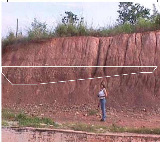
Figura N° 43 Se demarca un canal fluvial colmatado con brechas en matriz arcillosa en lutita.
