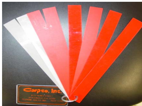
Figura 4.8: Regletas de calibración del separador Magnet-Lift.
