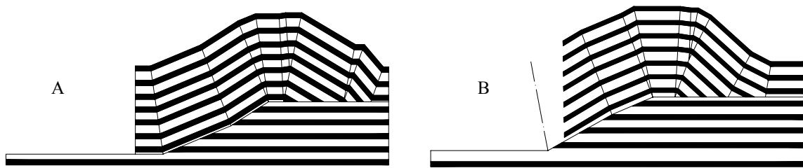
Figura A.16 Desarrollo de un fault-bend fold asociado a una rampa integrada por dos segmentos. A La falla es convexa hacia arriba. B La falla es cóncava hacia arriba. Modificado de Medwedeff y Suppe (1997).
