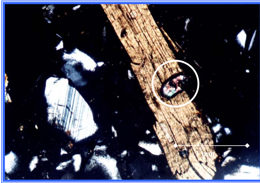
Figura 2.17: Vista de la sección delgada FCT-4, NX, Obj: 40/0,12x. Ocular: 12,5x. Circón con hábito prismático y alta figura de interferencia (circunferencia blanca) incluido en biotita.
