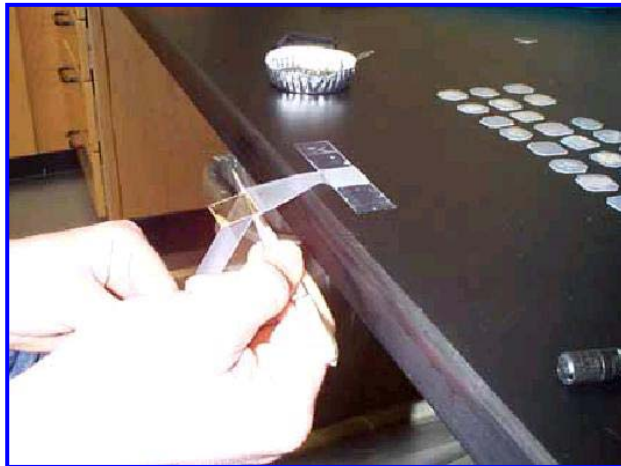
Figura 3.12: Separación de la mica necesaria para el montaje según la técnica del detector externo.
