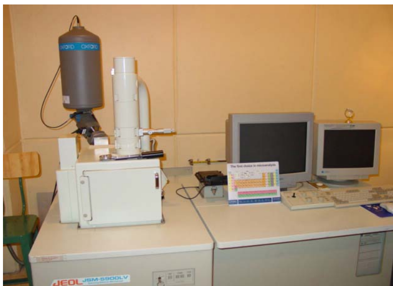
Figura 3.9: Microscopio electrónico de barrido de bajo vacío existente en el ININ, donde se analizaron las muestras de este Trabajo Especial de Grado.
