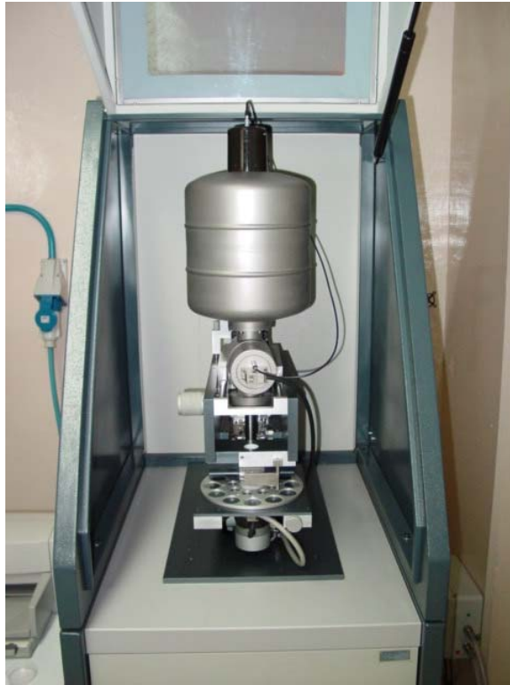
Figura 3.8: Espectrómetro de fluorescencia de rayos X, TX2000, del ININ, México.
