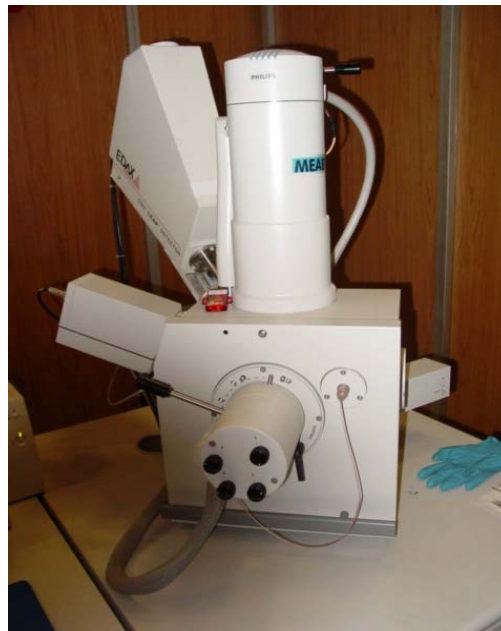
Figura 3.11: Microscopio electrónico de barrido de alto vacío del ININ, se utilizaron presiones entre 20 y 50 Kpa.
