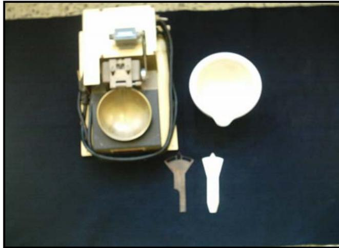
**Figura 16: Cuchara de Casagrande y ranuradores para suelos arenosos y suelos arcillosos.**
