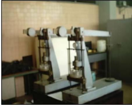
**Figura 18: Consolidómetro. Equipo para realizar el ensayo de consolidación.**
