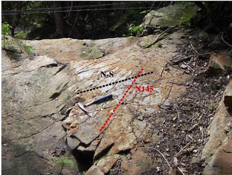
**Figura 15.** Principales orientaciones de las fracturas en la estación ST140.
