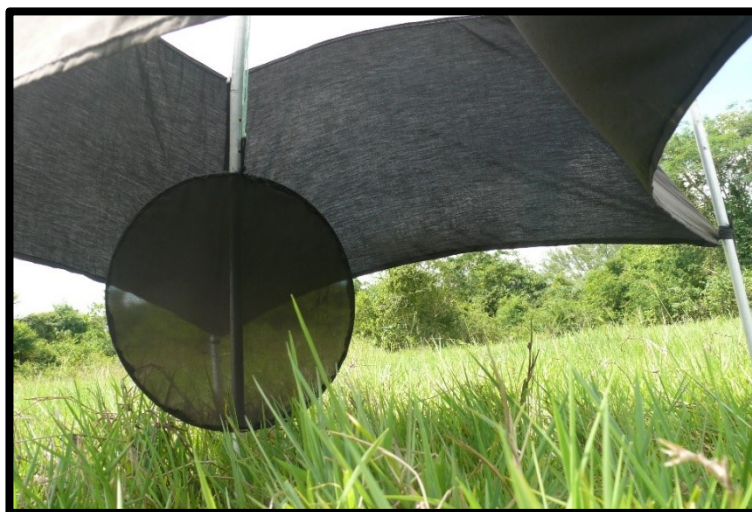
Figura 7. Atrayente visual en el interior de la trampa Canopy
