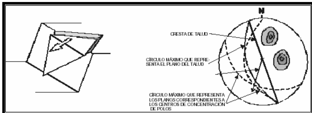
Figura 17. Rotura en Cuña de un macizo rocoso y su representación estereográfica.
