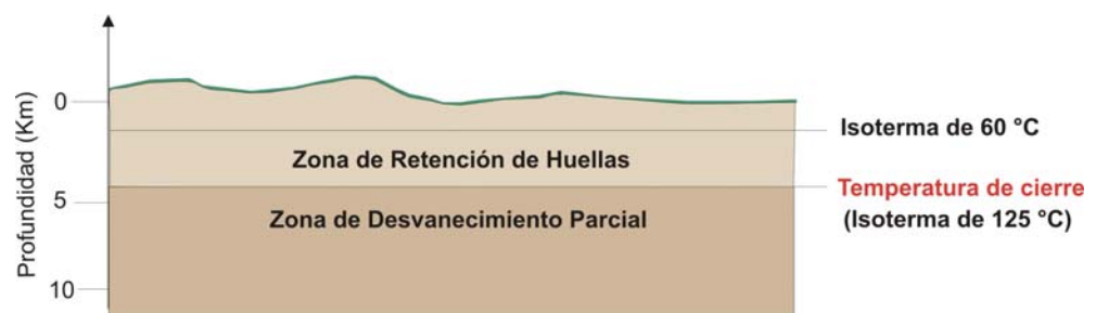
Figura 3.19. Gráfico ilustrativo de la temperatura de cierre y de las zonas de producción de huellas y de desvanecimiento parcial, en apatitos.
