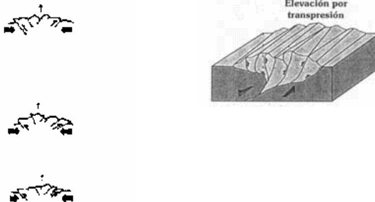
Figura 2.5. Estructura en flor, elevaciones tectónicas producidas en la zona de cizallamiento intenso y en momentos transgresivos (Tomado de www.usuarios.lycas.es/aepect/astenosfera/documentos )
