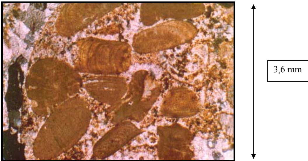
Fig. 42.- Algas rojas Crhodophycophyta con Lithophylun y Lithotamnium , caliza Grainstone. Muestra PI-144 Aumento: 4/0.12. Tomado de LABADY (1979)
