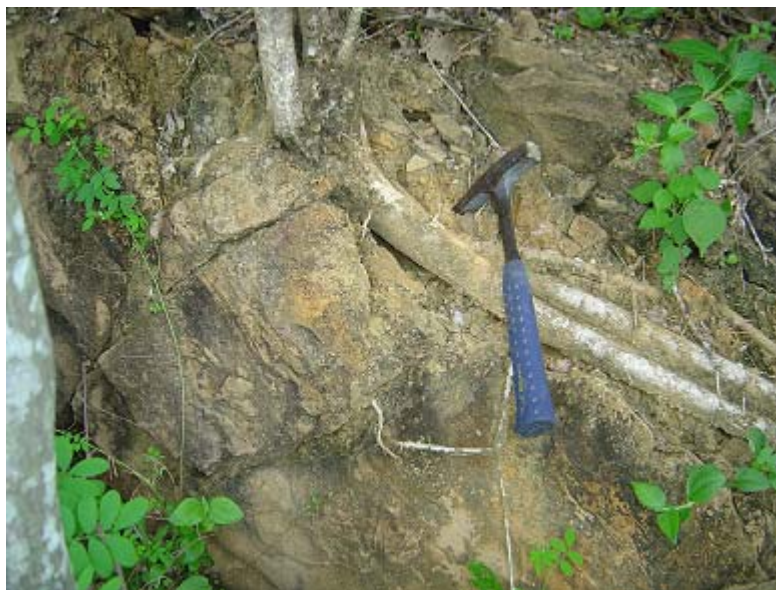
Figura 51. Afloramiento 065. Se ubica en la hoja 6449 – I – NO. Capa de arenisca con rumbo N85E 65N. Color fresco crema, color meteorizado pardo oscuro.
