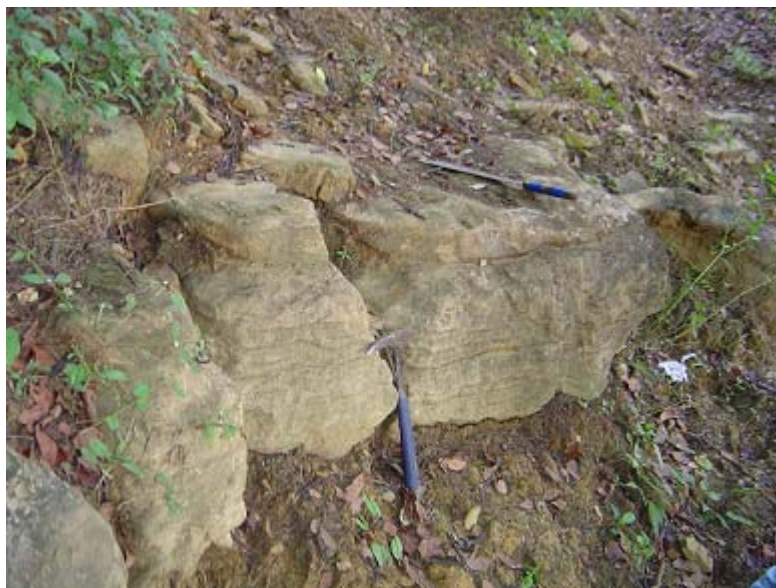
Figura 34. Afloramiento 044. Capa de caliza arenosa, con rumbo N25E 28N, intercalada con lutitas. Color fresco gris oscuro y color meteorizado pardo claro.
