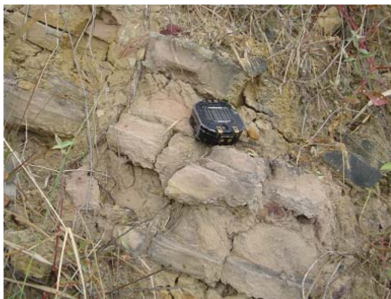
Figura 48. Afloramiento 051. Capa de arenisca con rumbo N75E 40N, se ubica en la hoja 6449 – IV – SO.
