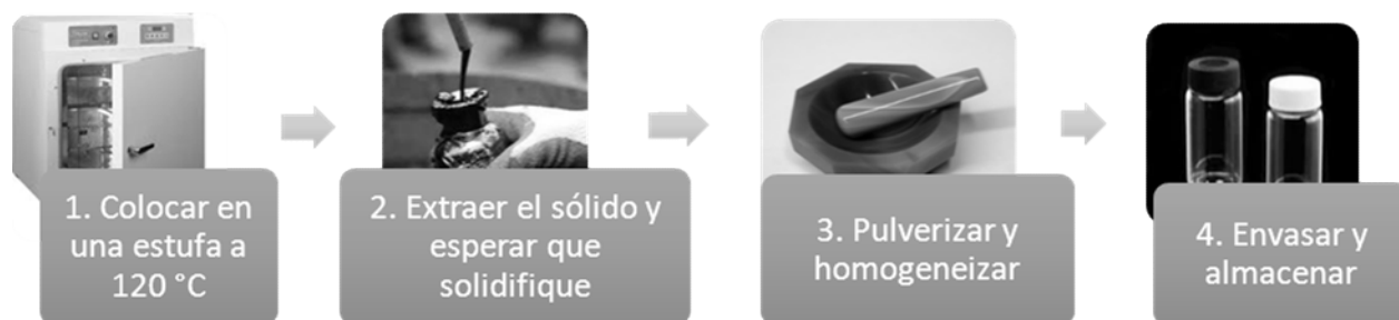
Figura 10. Esquema general del acondicionamiento previo de los residuos RVC, RB y RD
