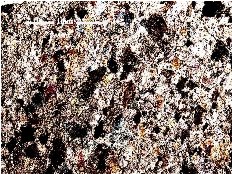
Fig. 35: Fotomicrografía M6. Objetivo 10x. Nícoles Cruzados. Cristales de piroxenos alterados por la meteorización que afecta la zona.
