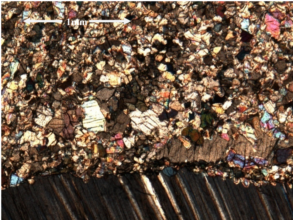
Fig. 81: Fotomicrografía M27. Objetivo 10x. Nícoles Cruzados. Pórfidos de piroxeno embebidos en una matriz de pequeños cristales de olivino.
