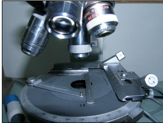
**Foto 1.5.** Microscopio usado en los estudios petrográficos, modelo Leitz Orthoplan, con platina graduable ajustable y graduada.
