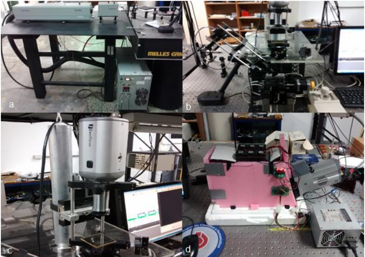
Figura 4.1.2. Imágenes de equipo LIBS: a) Fuente y cabeza del láser; b) Sistema de traslación X-Y-Z, óptica para la conducción del haz de láser y para la recolección de la emisión del plasma, y computador; c) Cámara de observación; d) Espectrográfo con revestimiento aislante, sistema de enfriamiento y cámara ICCD.
