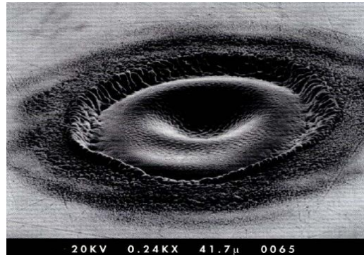
Figura 2.5.3.3. Micrografía de un “cráter” formado por ablación con láser en una superficie de cobre con el uso de un pulso de 30 ps de un láser Nd:YAG a \lambda = 1064 nm [26].
