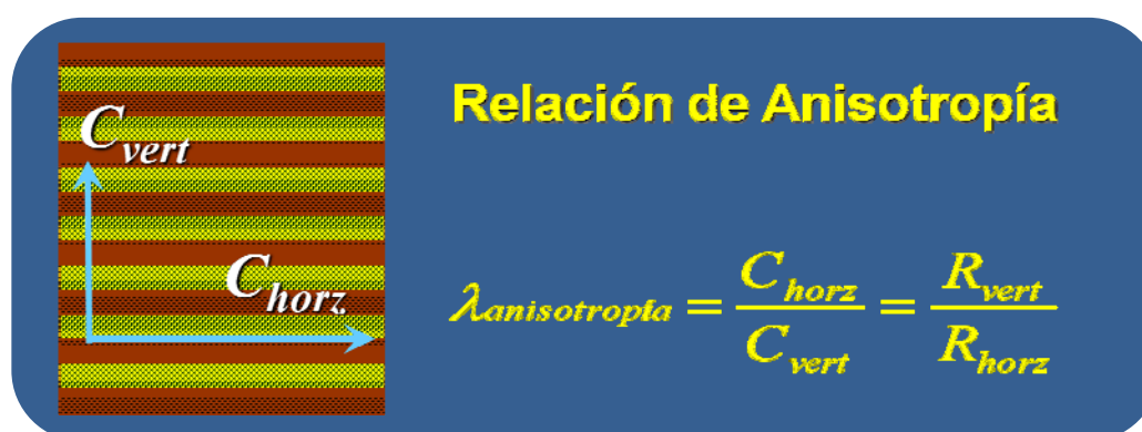
Figura 2.24 – Definición de la relación de anisotropía calculado como el cociente entre los valores de R–vertical sobre R–horizontal. Modificado de BAKER ATLAS LOGGING SERVICES, 2004.
