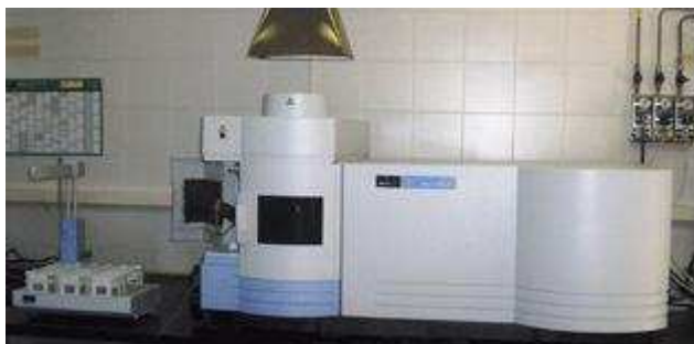
Fig. 8.- Espectrómetro de plasma con acoplamiento inductivo de emisión óptica (ICP-OES), PerkinElmer Óptima 5300 DV
