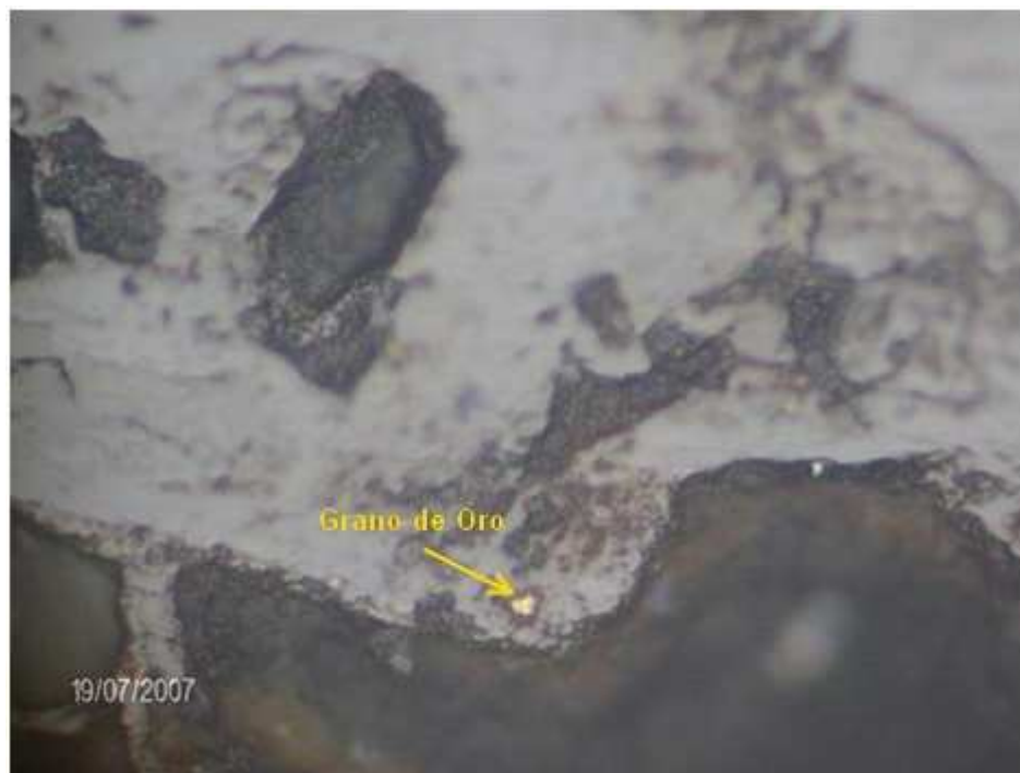
Fig. 19.- Grano de oro incluido en goethita ( N// ) (40x-Epi.10/0.25) Luz reflejada
