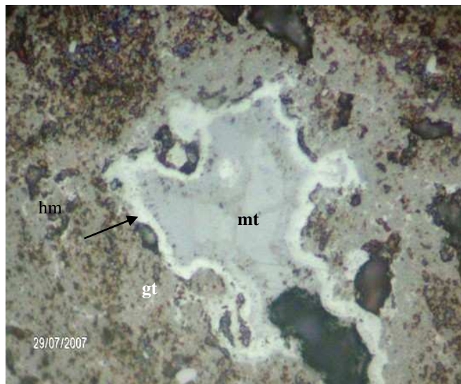
Fig. 22.- Aumento: (40x-Epi.10/0.25) Luz reflejada. Se observa magnetita (mt) anhedral, siendo sustituida por la hematita (hm) en los bordes (proceso de martitización) en medio de una masa de goethita.
