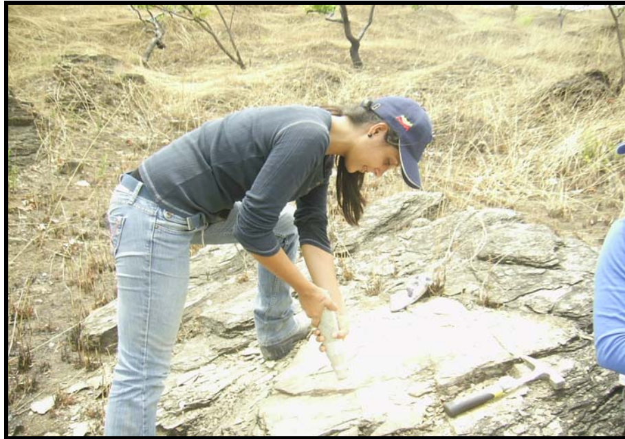
Figura 5.1. Ensayo con el Martillo de Schmidt o Esclerómetro Orientación: N 53° W. Tomada por: Maira Hernández
