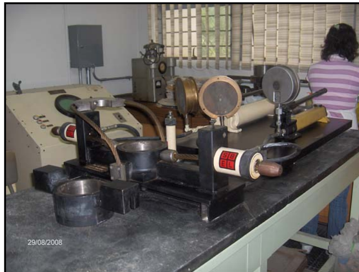
Figura 6.9. Equipo de Corte Directo, SBEL, RM-102. Laboratorio de Mecánica de Rocas, U.C.V.
