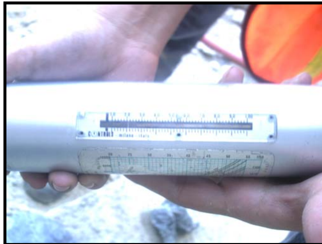
Figura 5.2. Medición de resistencia con el Martillo de Schmidt o Esclerómetro. Tomada por: Maira Hernández.
