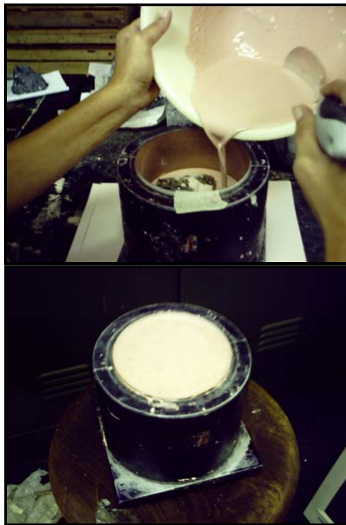
Figura 6.12. Montaje de la muestra para ensayo corte directo Tomada por: Rosangela Martínez (2008)
