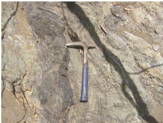
Figura 20. Contacto abrupto entre dique de basalto intrusionando en gabro.
