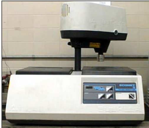
Figura 18 Equipo de desbaste y pulido Ecomet 5, marca Buehler. (vista Frontal)
