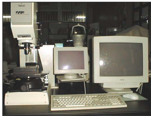
Figura 19 Perfilómetro de interferometría óptica ZYGO New View 200.
