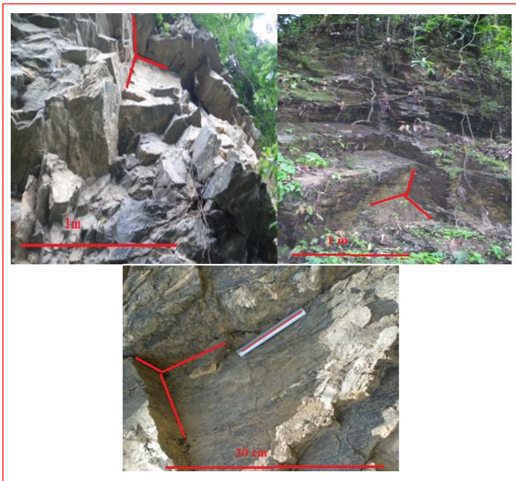
Figura #41. Representación de las distintas familias de diaclasas encontrados en la zona de estudio.
