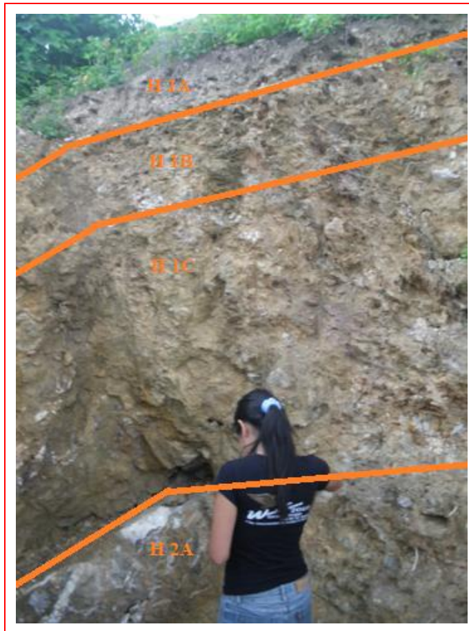
Figura #50. Perfil de meteorización representativo del Esquisto Las Mercedes. Fuente propia
