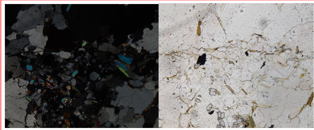
Figura #31. Fotos de la sección fina LM-012. Objetivo 4X. Nícoles cruzados: Presencia de textura nematoblástica y minerales micáceos orientados levemente. Nícoles paralelos: Minerales de Cuarzo, micáceos, Clorita, Granate y materia orgánica.
