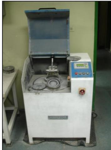
Figura 4. Equipo de molienda Shatter Box HERZOG, con morteros de carburo de tungsteno.
