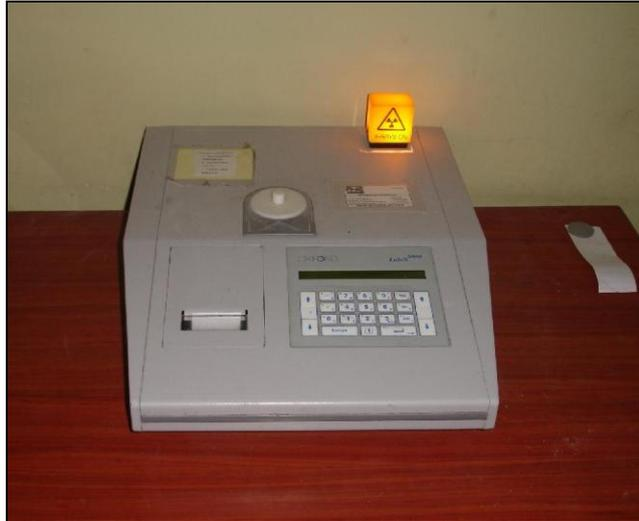
Figura 6. Espectrómetro XRF Oxford IB-LABX3000 de sobremesa.
