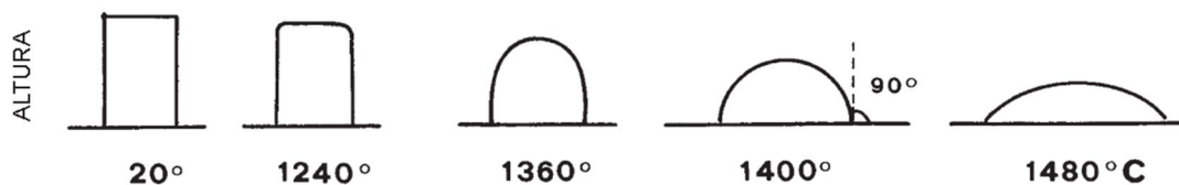
Figura N° 2: Ejemplo: secuencias del ensayo de fundencia para el feldespato (1240°C inicio de reblandecimiento, 1400°C punto de fusión). Tomado de SACMI (2004).
