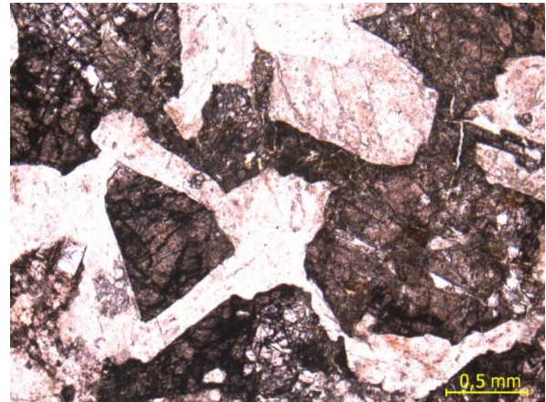
Fig. C10. LA-1200-C. Cristales de plagioclasa dentro de cristales de clinopiroxeno, generando una textura ofítica. (NP)
