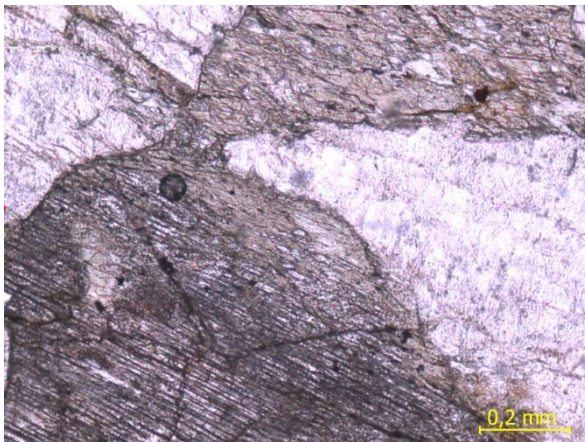
Fig. C55. LA-1202-E1. Clinopiroxeno alterando a anfíbol (NP).
