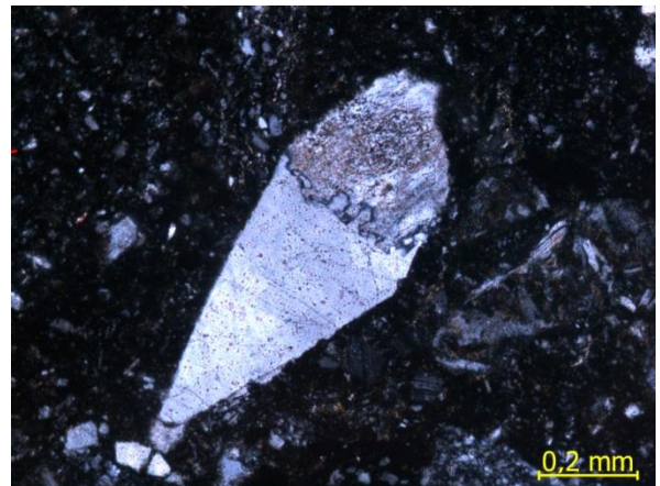
Fig. C81. LA-1203-A. Plagioclasa que presenta alteración a sílice (NP).
