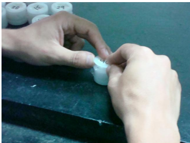
Figura A8. Preparación de las muestras en los cilindros de plástico, para luego introducirlos en el Minipal .
