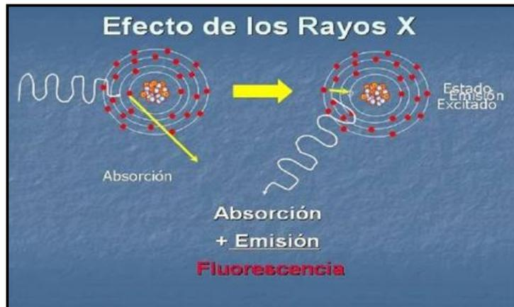
Figura 67. Esquema del proceso de generación de fluorescencia de rayos X
