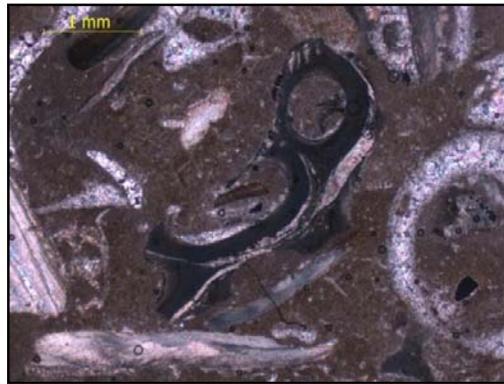
*Figura 46. Fotomicrografía de la muestra PG21-M-16, Facies II, en la cual se observan fragmentos de molusco con inversión homoaxial y heteroaxial.*
