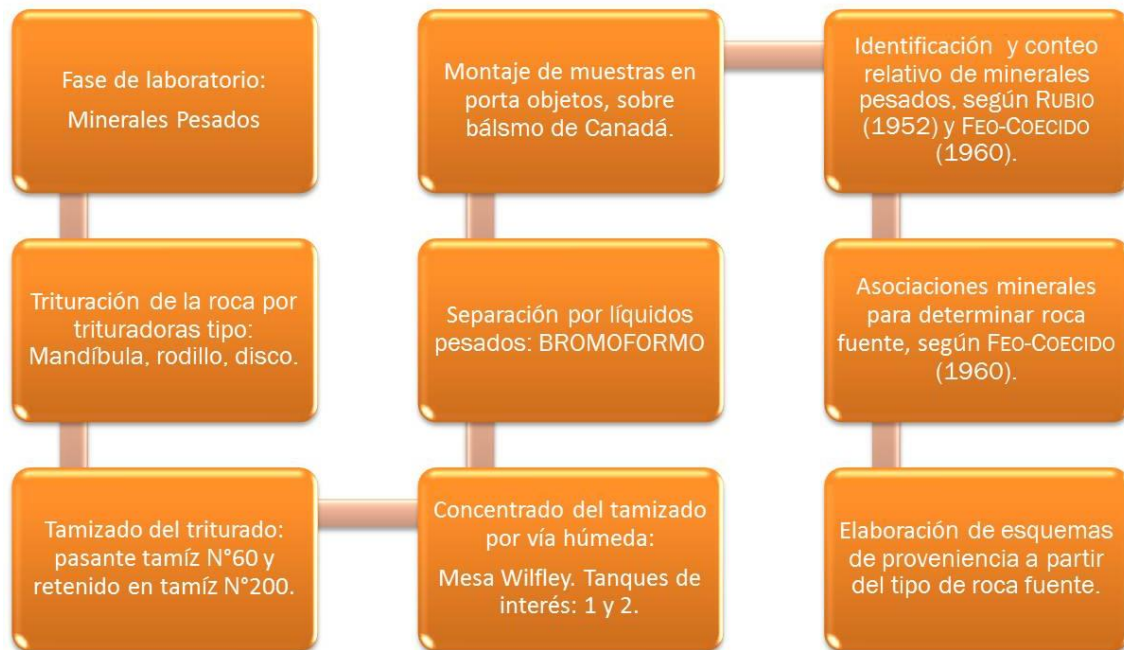
Figura 14. Diagrama resumen para el tratamiento de muestras para la concentración de minerales pesados en laboratorio.
