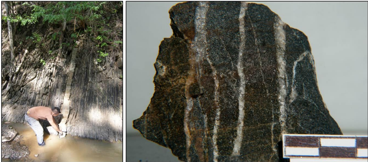
Figura 59. Izquierda: Afloramiento de intercalación monótona de areniscas y lutitas grises oscuras en el río Macaira. Derecha: muestra de arenisca G-20, de color gris oscuro meteoriza a pardo anaranjado, con vetillas de cuarzo.
