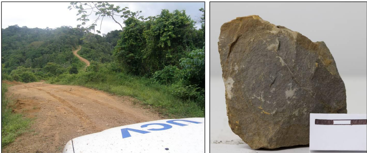
Figura 70. Izquierda: caminos de tierra hacia la localidad de Batatal. Derecha: muestra G-27, arenisca de color gris meteoriza a pardo, de grano fino.
