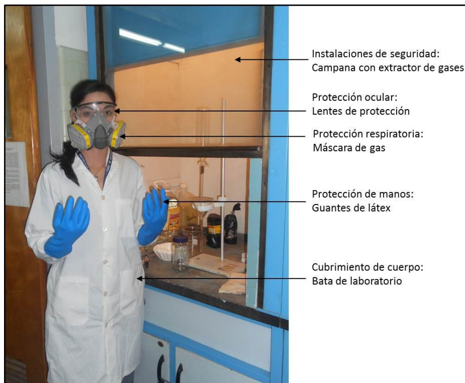
Figura 22. Implementos de seguridad utilizados en el proceso de separación de minerales pesados por el método de líquidos pesados.
