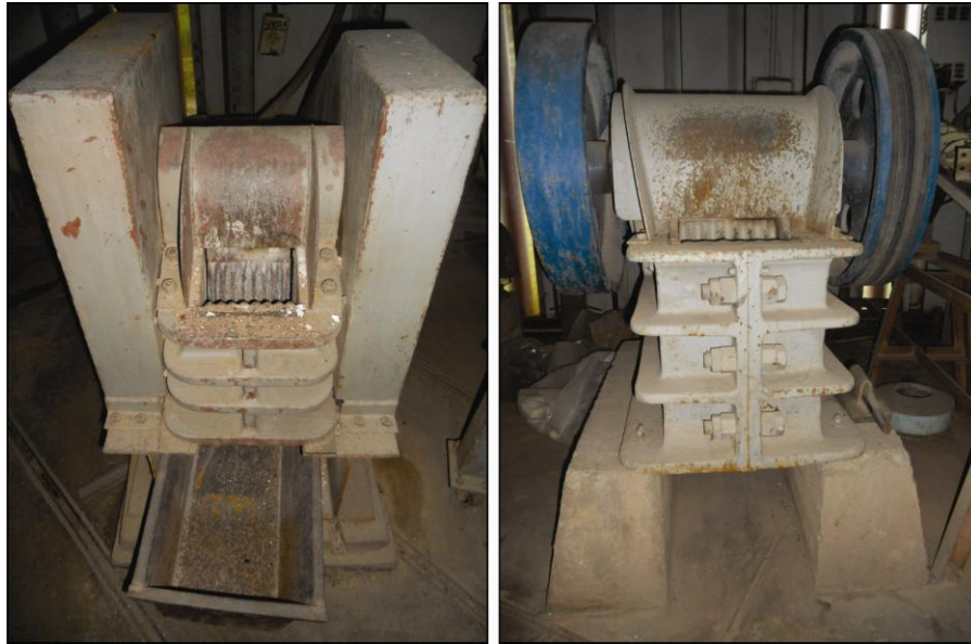
Figura 15. Máquinas trituradoras de mandíbula ubicadas en el Laboratorio de Geología y Minas. Izquierda: trituradora de bloques a tamaño canto. Derecha: trituradora de cantos a tamaño guijarro.
