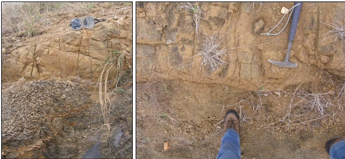
Figura 26. Izquierda: cuerpo de arenisca de color pardo, fuertemente diaclasada intercalada con lutita gris oscura olivácea con fractura astillosa característica. Derecha: vista en planta del contacto erosional entre el cuerpo de arenisca y el conglomerado.
