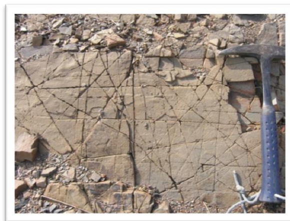
Figura C37. Arenisca fuertemente diaclasada, se registran al menos dos familias de diaclasas ortogonales entre sí.
