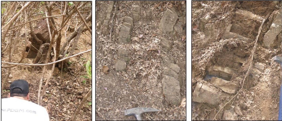
Figura 32. Afloramiento en G-05 cubierto en su mayoría, se observan capas de arenisca, intercaladas con lo que parecen ser las lutitas muy meteorizadas a suelos pardos.
