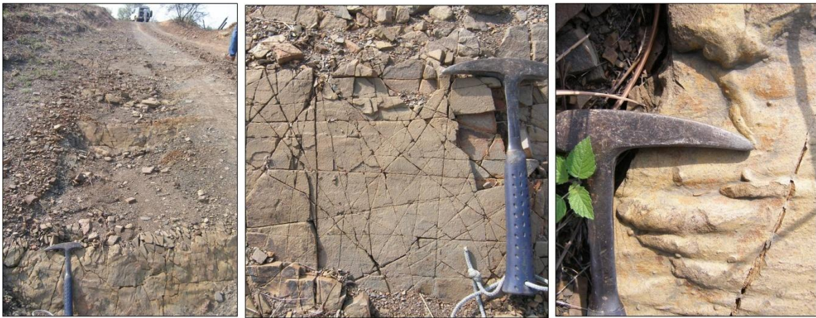
Figura 36. Izquierda: capas de arenisca se observan en el camino de tierra. Centro: arenisca de color gris verdosa fuertemente diaclasada, se registran al menos dos familias de diaclasas ortogonales entre sí. Las lutitas son grises y meteorizan a colores pardos claros. Derecha: turboglifos en canto de arenisca.
