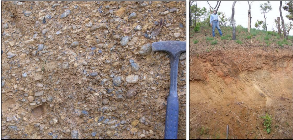
Figura 31. Izquierda: Conglomerado con clastos de tamaño entre 0,5 a 4 cm aproximadamente, de composición variada. Derecha: Afloramiento en corte de carretera donde se observan capas gruesas de arenisca intercaladas con conglomerados.
