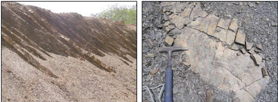
Figura 33. Izquierda: afloramiento de intercalación de areniscas y lutitas, al norte de Las Lajitas, característica de la Fm. Guárico. Derecha: capa de arenisca fuertemente diaclasada.
