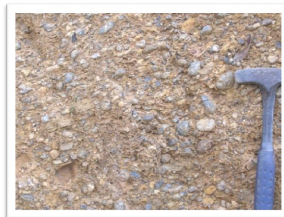
Figura C13. Conglomerado con clastos de tamaño entre 0,5 a 4 cm aproximadamente, de composición variada. Se toman las muestras de clastos G-04B.1 y G-04B.2.
