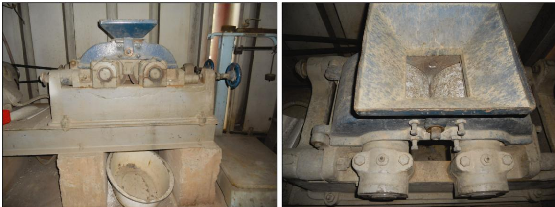
Figura 16. Máquina trituradora de rodillos ubicada en el Laboratorio de Geología y Minas.
