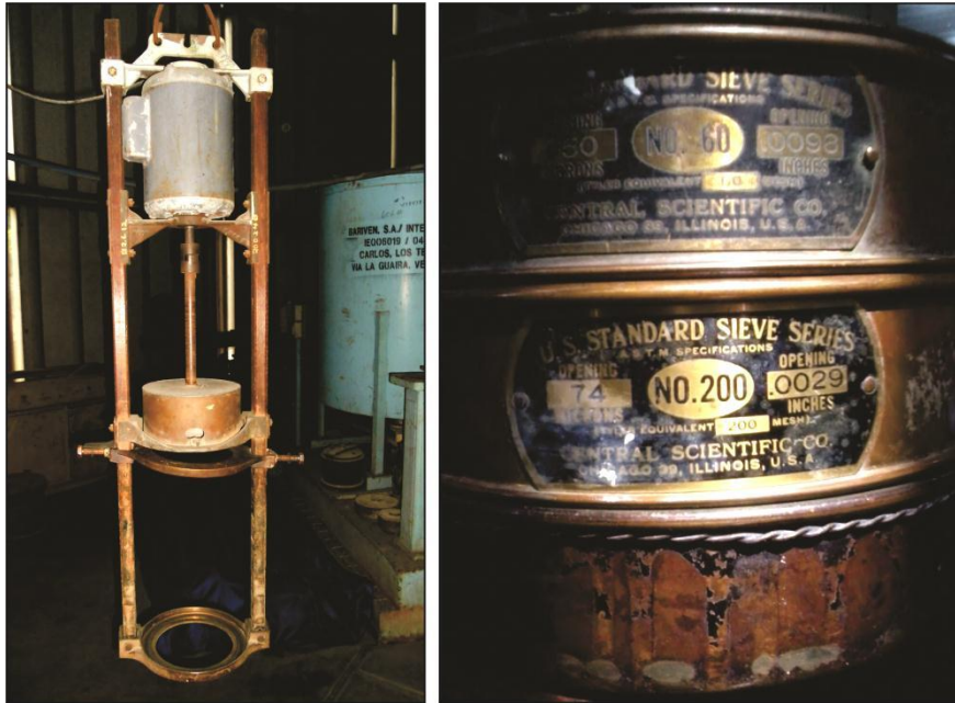
Figura 18. Izquierda: Tamizadora ubicada en el Laboratorio de Geología y Minas. Derecha: Tamiz 60 y 200 utilizadas para el tamizado de las muestras.
