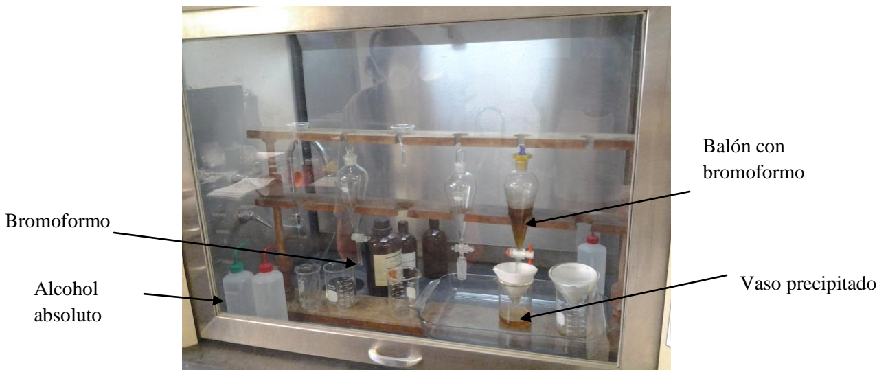
Figura 29. Separación de minerales mediante bromoformo, Laboratorio de termocronología de la escuela de Geología, Minas y Geofísica, U.C.V
