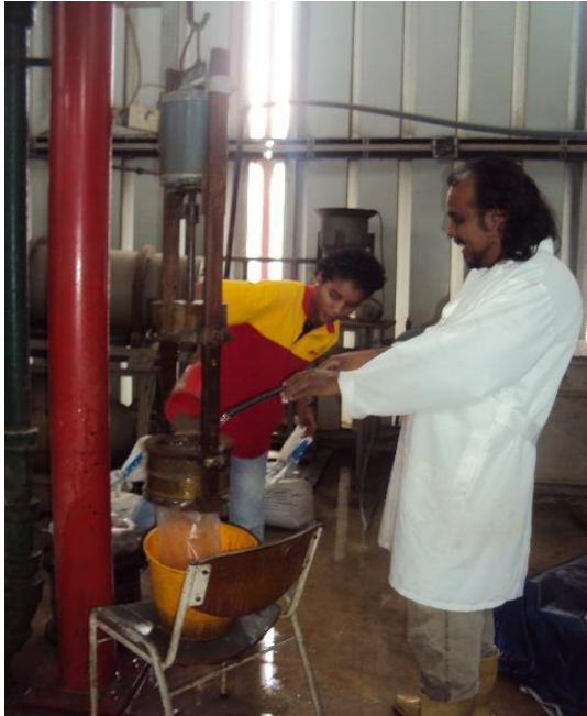
Figura 22. Tamizado de la muestra en húmedo. Laboratorio de la escuela de Geología, Minas y Geofísica, U.C.V
