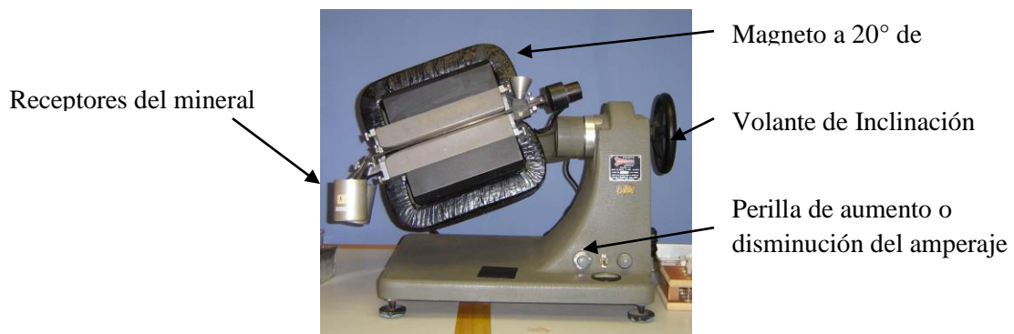
Figura 33. Separador Magnético Frantz, Laboratorio de termocronología de la escuela de Geología, Minas y Geofísica, U.C.V
