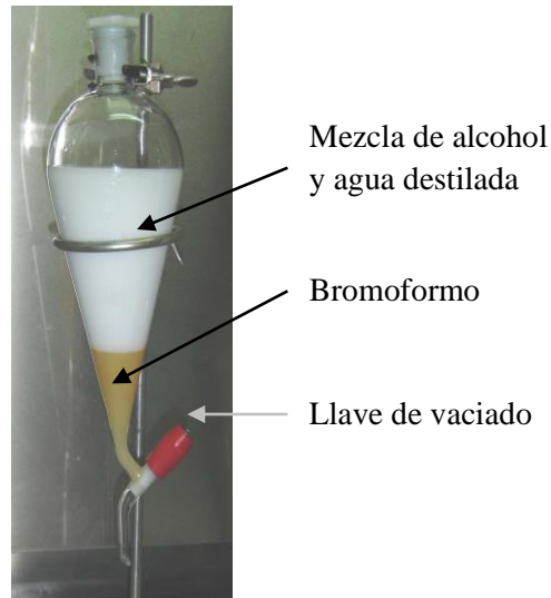
Figura 32. Precipitación del Bromoformo en el embudo.
