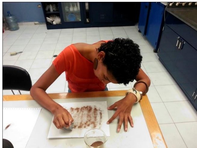
Figura 26. Proceso de separación de magnetita de la muestra
