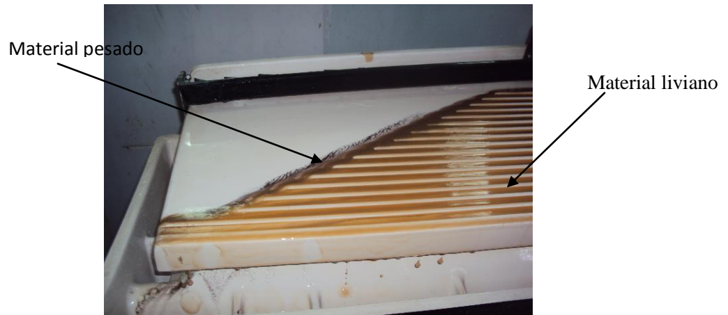
Figura 24. Separación de los minerales pesados, Laboratorio de la escuela de Geología, Minas y Geofísica, U.C.V
