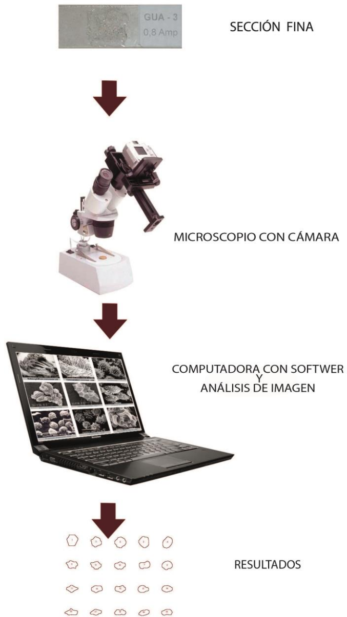
Figura 42. Secuencia de pasos realizada para el análisis digital de minerales pesados.
