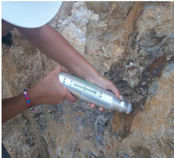
Figura N° 113. Medidas con el Esclerómetro.
