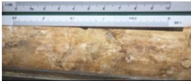
Figura N° 48. Núcleo extraído de la perforación P-11 profundidad 0.55-2m
