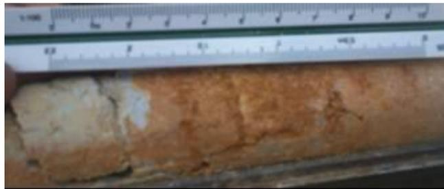
Figura N° 40. Núcleo extraído de la perforación P-07 profundidad 0.55-3m
