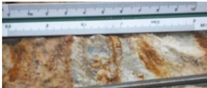
Figura N° 37. Núcleo extraído de la perforación P-05 profundidad 3-12 m. Presencia de calcita
