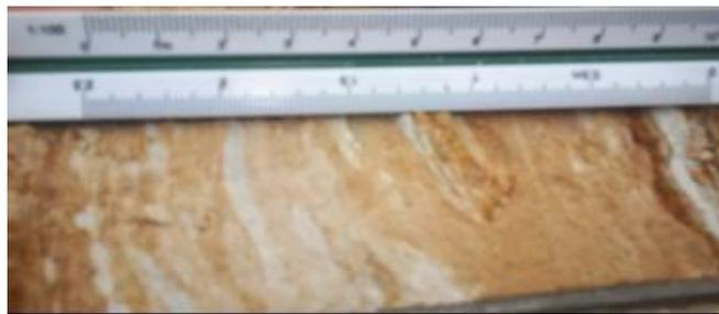
Figura N° 36. Núcleo extraído de la perforación P-05 profundidad 0.55-3 m, nótese la calcita en los espacios interfoliados
