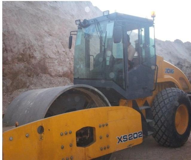
Figura N° 112. Vibrocompactadora.
