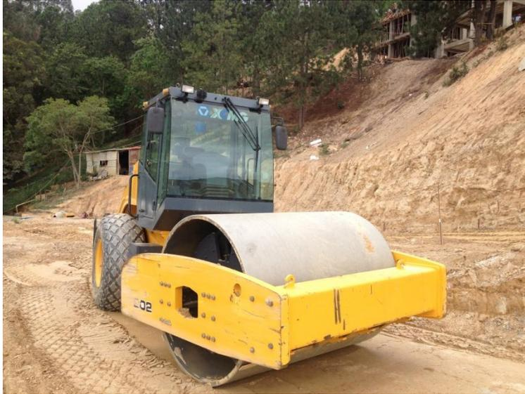
Figura N° 19. Vibrocompactadora XCMG
