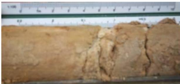
Figura N° 32. Núcleo extraído de la perforación P-03 profundidad 0.55-2 m.
