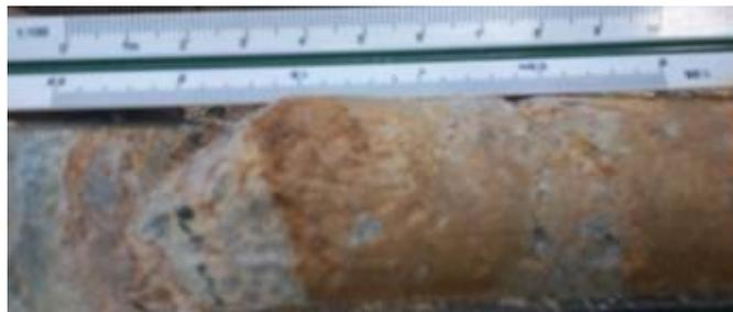
Figura N° 41. Núcleo extraído de la perforación P-07 profundidad 3.55-14m
