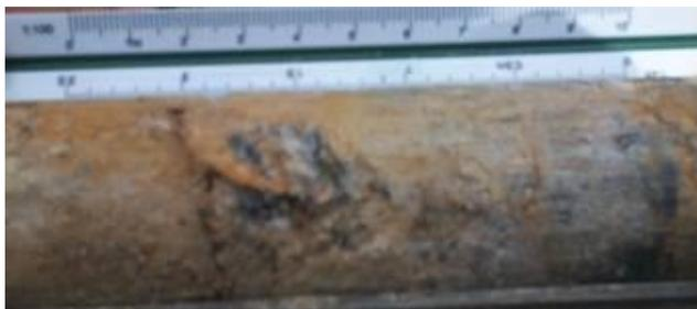
Figura N° 43. Núcleo extraído de la perforación P-08 profundidad 3.55-10m
