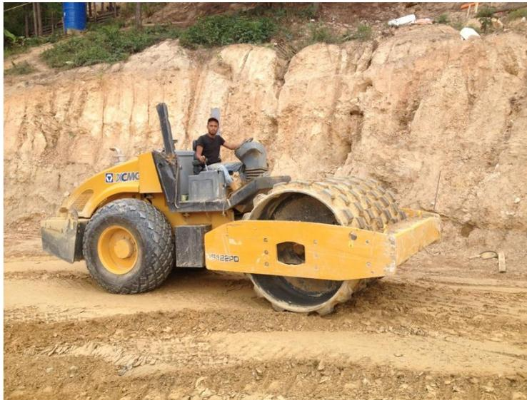
Figura N° 20. Compactadora XCMG, tipo Pata de cabra
