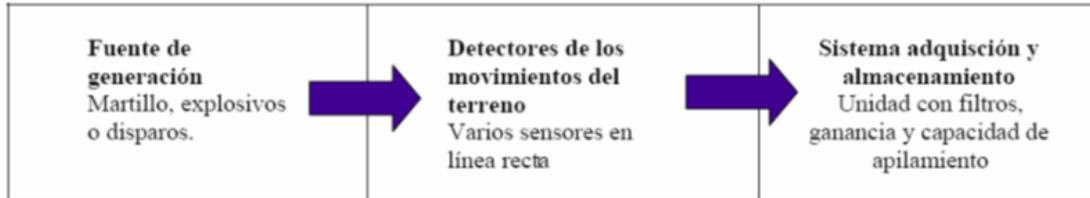
Figura N° 4, Esquema general del equipo de refracción sísmica. (Martín, 2008).
