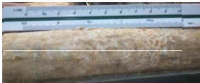
Figura N° 45. Núcleo extraído de la perforación P-08 profundidad 2.55-15m
