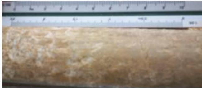
Figura N° 46. Núcleo extraído de la perforación P-10 profundidad 0.55-2m
