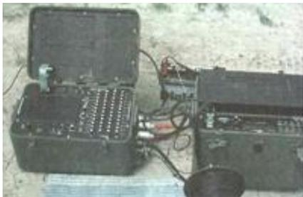
Figura N° 7. Sismógrafo ES2415F de EG&G.
