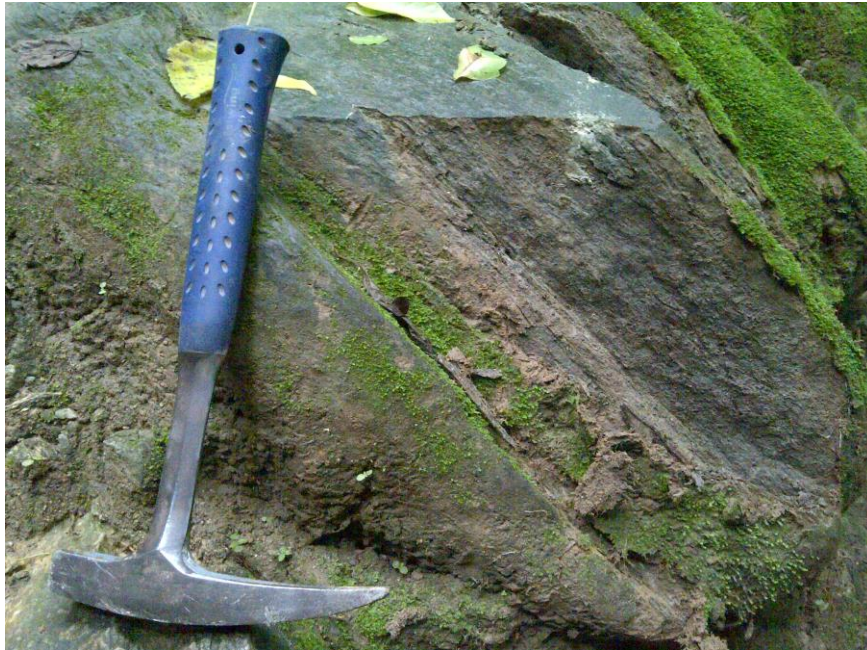
Figura 4.18. Afloramiento 14 de la Avenida Boyacá, el cual se encuentra a una altura de 1000msnm y presenta unas coordenadas GPS de N 1.162.985 y E 735.140, en ella se presenta una familia de diaclasa con alto grado de meteorización.
