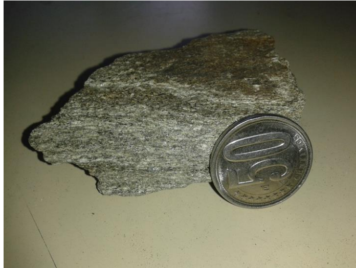
Figura 4.30. Muestra de mano MP4. Presenta alto contenido de micas, marcada foliación y se observan colores característicos de la meteorización.
