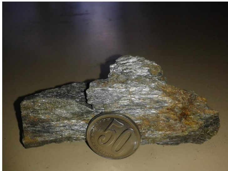
Figura 4.28 Muestra de mano MP3. Presenta foliación marcada, manchas de óxido producto de la meteorización y alto contenido de moscovita.
