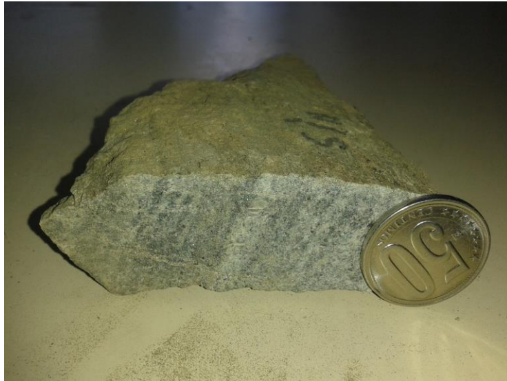
Figura 4.34. Muestra de mano MP6. Muestra foliación y coloración marrón pardo producto de la meteorización.
