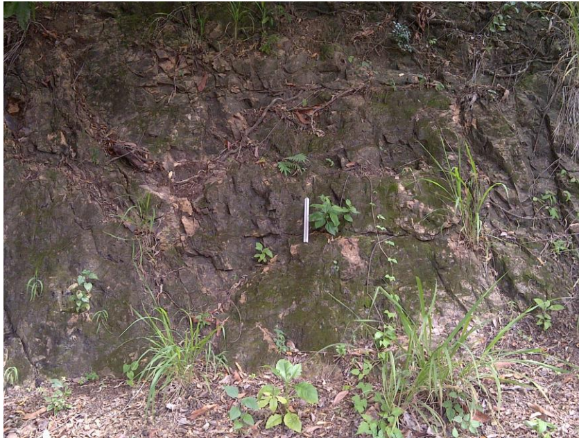
Figura 4.10. En esta imagen se aprecia el Afloramiento 13 de la Avenida Boyacá, el cual se encuentra a una altura de 1000msnm y presenta unas coordenadas GPS de N 1.161.895 Y E 739.025, en ella se observa un esquisto cuarzo moscovítico. Presenta una familia de diaclasas.
