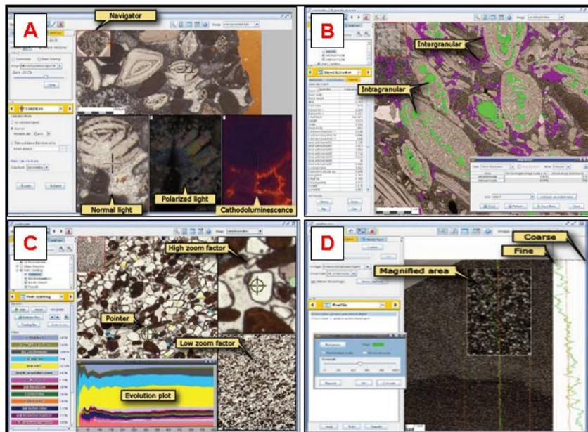
Figura N° 18. Herramientas y características del JMicroVision 1.2.7. A) Visión simultánea de varias imágenes con diferentes aumentos y modos de iluminación. B) Clasificación de distintos tipos de poros. C) Conteo digital de puntos. D). Perfil de variación granulométrica (Tomado de [www.jmicrovision.com](http://www.jmicrovision.com)).
