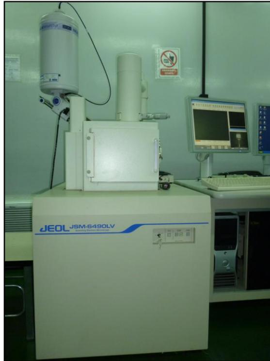
Figura N° 30. Microscopio Electrónico de Barrido (JEOL- Modelo JSM-6490LV) utilizado en este estudio. (Equipo en PDVSA-INTEVEP\*)
