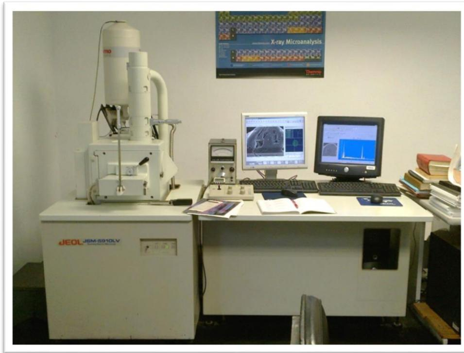
**Figura 12:** *Microscopio electrónico de barrido (Jeol JSM-5910 LV) equipado con un espectrómetro de rayos X (MEB-EDX). (INGEOMIN)*
