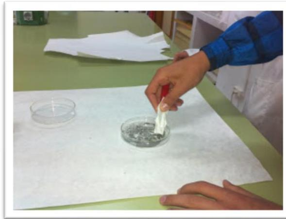
**Figura 6:** *Separación magnética manual*
