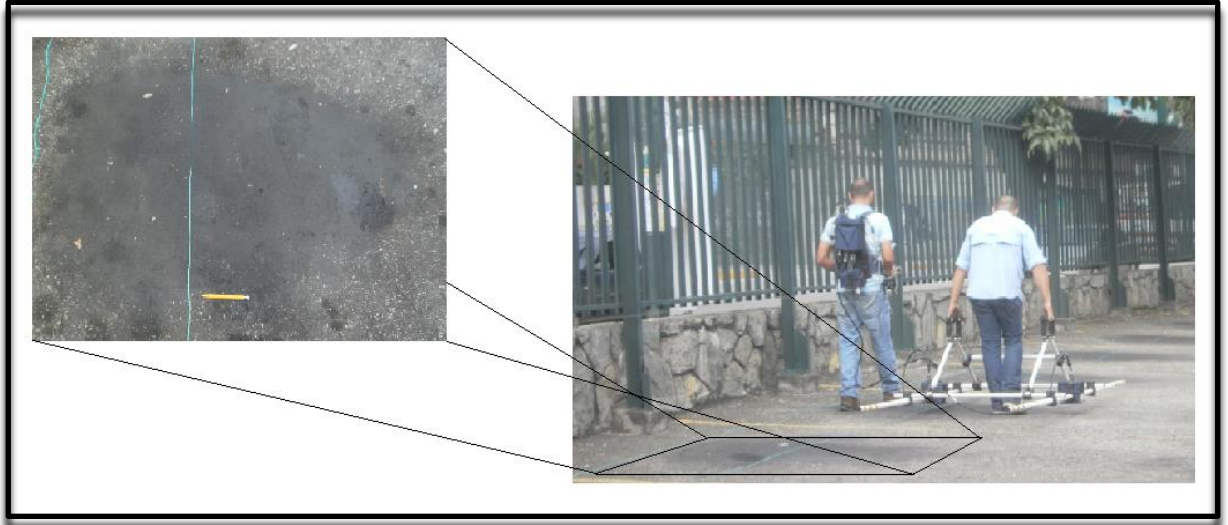
Figura 44. Derecha, Momento en que se obtuvo radargrama para perfil T1, con antena de 40 MHz Izquierda, ampliación de una de las manchas de fluido.
