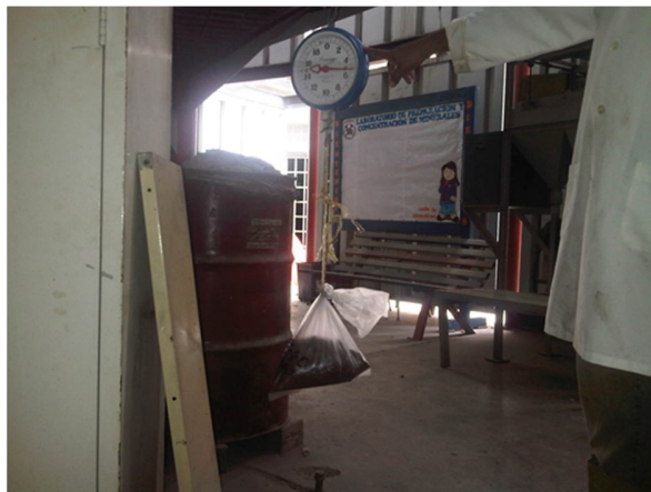
Figura 33. Pesado de la muestra después de la última trituradora.
