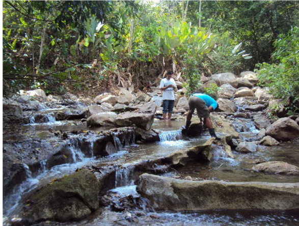
Figura 30. (a) Toma de muestra se tamiza y se lleva a la batea. (b) Separación hidrogravimétrica en la batea. (c) Después de separar los minerales pesados se introducen en una bolsa ziploc con identificación. (d) Muestra recolectada después del uso de la batea. (e) Toma de Muestra Bolsa de 20 Kg, para tratar en Laboratorios. (f) Toma de Muestra In-Situ. (g) Registro de Posición GPS.
