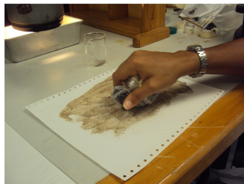
Figura 37. Separación de minerales magnéticos manual con el imán.
