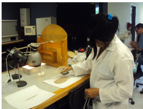
Figura 37. Separación de minerales magnéticos manual con el imán.
